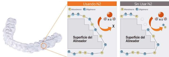
Cambio de estado de la superficie del alineador con y sin N2, muestra por qué necesita N2 para el poscurado
